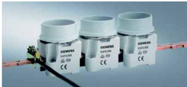
Навесные цоколи предохранителей DIAZED DII для 25 А, 5SF6 005 с исполнением зажимов „В“ установлены на сборную шину EZR 5SH3 54. Подводящие провода закреплены при помощи навесного зажима 8JH4 122. Сборную шину можно нагружать до 150 А.
