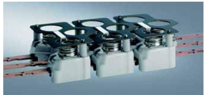
Трёхфазные навесные цоколи предохранителей DIAZED DII для 3 x 25 А, 5SF2 07 с исполнением зажимов „B“ установлены на 3 сборные шины EZR 5SH3 54. Каждую из сборных шин можно нагружать до 150 А.
