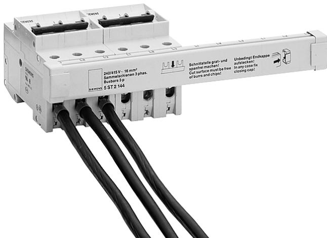
Одновременное подключение подходящих снизу проводов сечением до 25 мм<sup>2</sup> и трехполюсной сборной шины 5ST2 144 к комбинированному зажиму автоматического выключателя.
