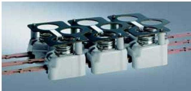
Навесные цоколи предохранителей DIAZED DII 3-фазные для 3 x 25 А, 5SF2 07 с исполнением зажимов „В“ установлены на 3 сборные шины EZR 5SH3 54. Каждую из сборных шин можно нагружать до 150 А.
