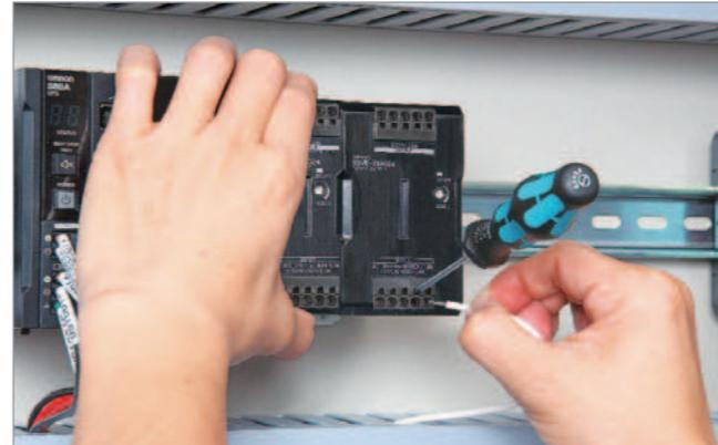
**Возможно подключение многожильных витых проводов**
