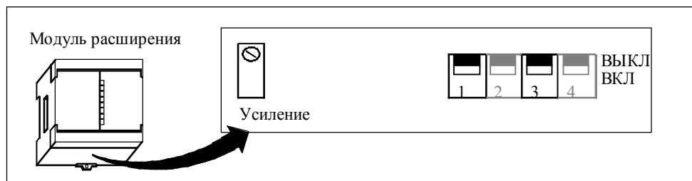
Рис. А-28. Калибровочный потенциометр и двухпозиционный переключатель конфигурации
