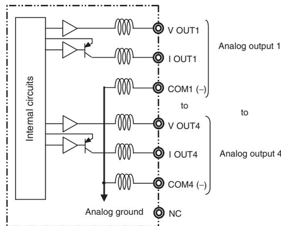
■ **Wiring for Analog Outputs**
