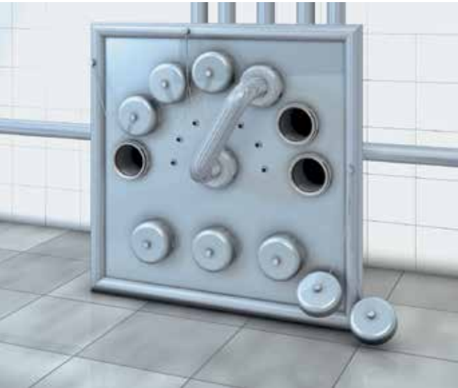
Контроль положения перемычки разделительного узла на линии по производству напитков.
