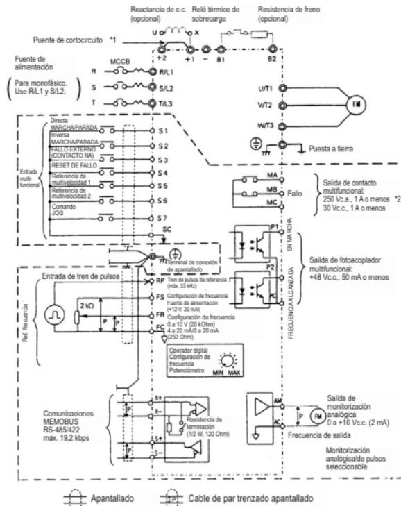
• : Los terminales del circuito de control sólo disponen de aislamiento básico (Clase de protección 1, Categoría de sobretensión III). Es posible que sea necesario un aislamiento adicional en los extremos de conexión del producto para cumplir con las normativas CE.
