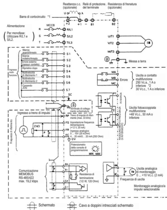
..... : Per i terminali del circuito di controllo viene fornito solo un isolamento di base (classe di protezione 1 e categoria di sovratensione II). Il prodotto finale potrebbe richiedere un isolamento aggiuntivo per essere conforme allo standard CE.
