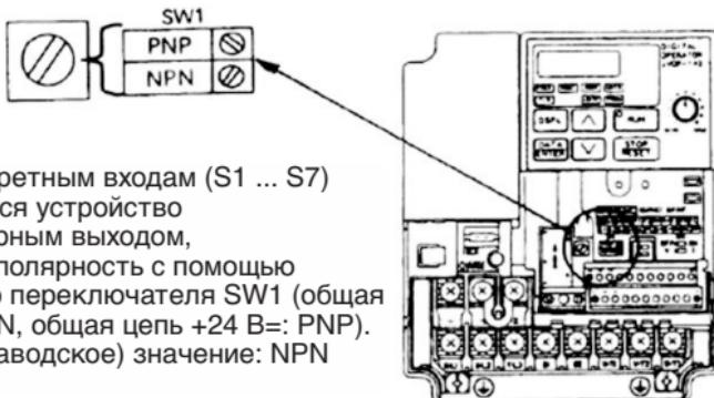
Если к дискретным входам (S1 ... S7) подключается устройство с транзисторным выходом, установите полярность с помощью поворотного переключателя SW1 (общая цепь 0В: NPN, общая цепь +24 В: PNP). Исходное ( заводское ) значение: NPN
