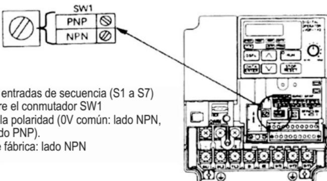
Cuando conecte entradas de secuencia (S1 a S7) con transistor, gire el commutador SW1 dependiendo de la polaridad (0V común: lado NPN, +24 V común: lado PNP).
