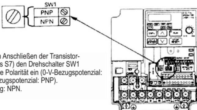
Stellen Sie beim Anschließen der Transistor-eingänge (S1 bis S7) den Drehschalter SW1 auf die passende Polarität ein (0-V-Bezugspotenzial: NPN, +24-V-Bezugspotenzial: PNP). Werkseinstellung: NPN.
