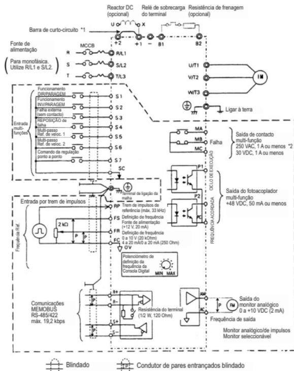
: Apenas é fornecido o isolamento base (classe de protecção 1, categoria II para sobretenção) para os terminais do circuito de controlo. Pode ser necessário isolamento adicional no produto final para estar de acordo com os requisitos CE.
