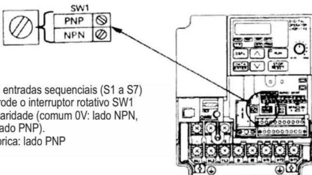
Quando ligar as entradas sequenciais (S1 a S7) com transistor, rode o interruptor rotativo SW1 consoante a polaridade (comum 0V: lado NPN, comum +24 V: lado PNP).
