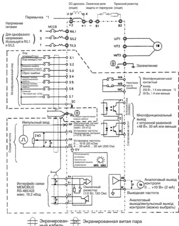
Для клемм схемы управления предусмотрена только базовая изоляция (класс защиты 1, категория защиты от перенапряжения II). Для обеспечения соответствия требованиям СЕ в конечной системе, возможно, потребуется предусматривать дополнительную изоляцию.
