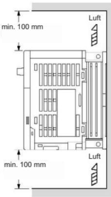
\*: Freiraum bei Frequenzumrichtern mit 5,5/7,5 kW Leistung: min. 50 mm
