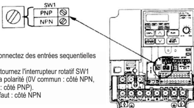
Lorsque vous connectez des entrées séquentielles (S1 à S7) avec transistor, tournez l'interrupteur rotatif SW1 en fonction de la polarité (0V commun : côté NPN, +24 V commun : côté PNP).
