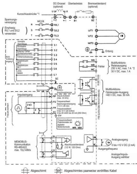
: Die Steuerklemmen sind nur mit einer Basisisolierung (Schutzklasse 1, Überspannungskategorie II) versehen. Möglicherweise ist eine zusätzliche Isolation im Endprodukt erforderlich, um die Konformität mit den CE-Anforderungen zu erzielen.
